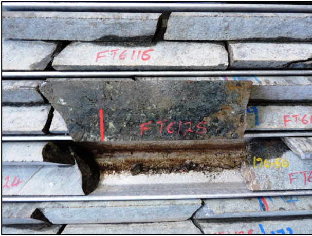
Blebby Ni-Cu sulphide mineralisation in drill hole 2019.
